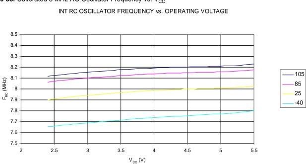
CALIBRATED 8MHz RC OSCILLATOR FREQUENCY vs. TEMPERATURE
